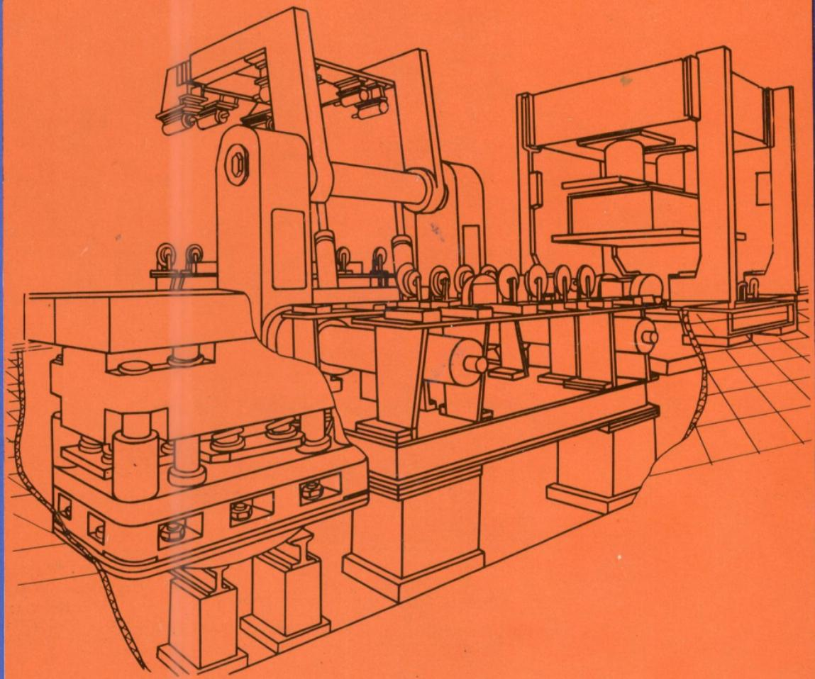
Установки литьевые формовочные предназначены для изготовления полуформ в опоках с размерами в свету  $1000 \times 800$  мм,  $1200 \times 1000$  мм,  $1600 \times 1200$  мм в литьевых цехах с единичным и мелкосерийным характером производства и в составе механизированных формовочных линий для серийного и крупносерийного производства литья.
